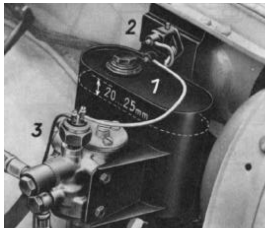
Bild H 15. Hydraulikölbehälter
