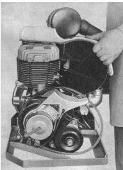
Bild M 13. Kühlluftgehäuse abnehmen
