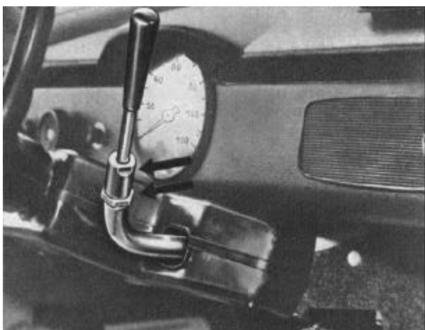
Bild H B. Schalthebel - Einstell- und Kontermutter
