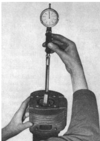
Bild M 36. Zylinderbohrung messen
