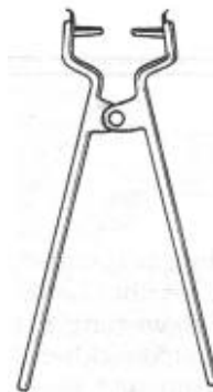
Zange zum Aus- und Einhängen der Bremsbacken
