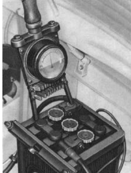
Bild E 13. Batteriespannung überprüfen
